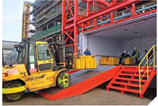
Note : 사진은 무피트 경사램프형·피트형은 바닥면과 수평 진출입 The infinite slope ramp type and the feet type are horizontally advanced with the bottom surface.
